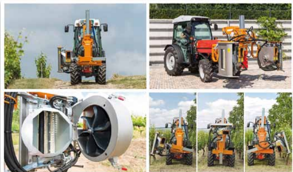
FIGURA 2. Molti modelli recenti sono disponibili sia in versione singola che doppia (in quest'ultimo caso per poter lavorare sulle pareti di due filari adiacenti, sopra); le versioni singole hanno spesso la possibilità di rotazione di 180° della testata (sotto, a destra) (cortesia: Binger).
