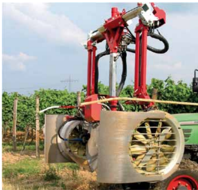
FIGURA 3. Nella defogliatrice a lame le foglie vengono orientate verso una coppia di coltelli rotanti tramite un flusso d'aria in aspirazione generato da un potente ventilatore (cortesia: Ero).
