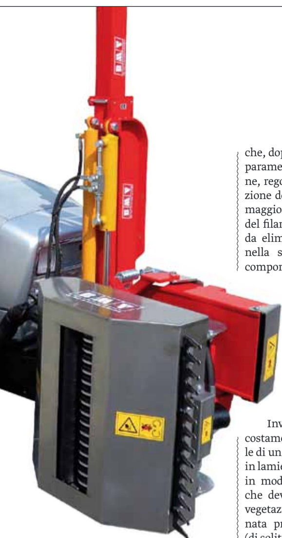
FIGURA 5. In aggiunta ai rulli "mungitori", sulle defogliatrici a rotori contrapposti qualche costruttore monta anteriormente alla zona di intervento una piccola barra falciante, che provvede a sfolire preliminarmente la vegetazione (cortesia: Bmv).
