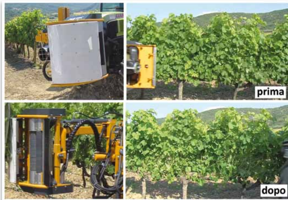
FIGURA 4. Le moderne defogliatrici si avvalgono dell'accostamento automatico per la regolazione dell'intensità di intervento, basato su un pannello (in alto a sinistra) che rileva e mantiene costante la pressione sulla canopy tramite la continua variazione della posizione della testata (cortesia: Volentieri-Pellenc).
