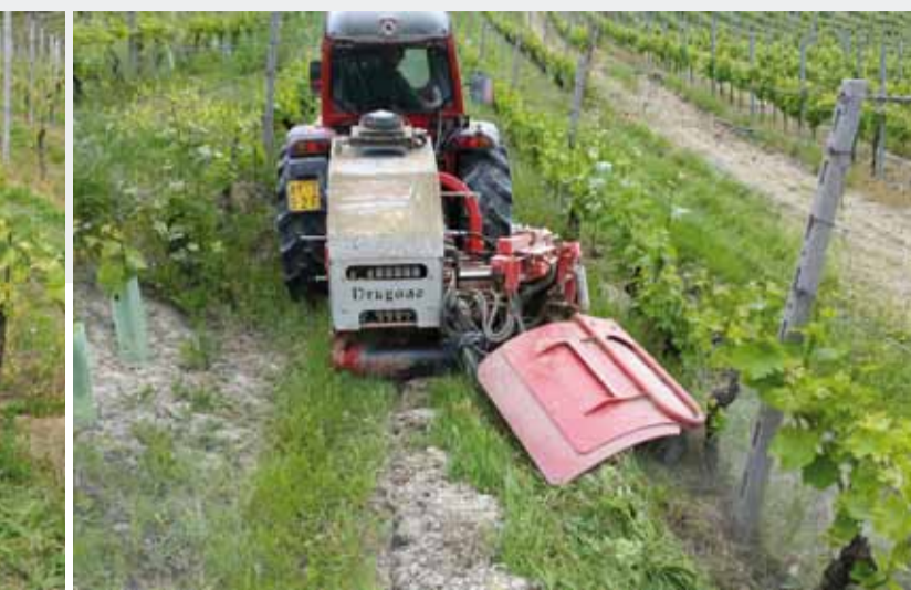
FIGURA 4 - Macchina per il diserbo meccanico (trinciatrice)
